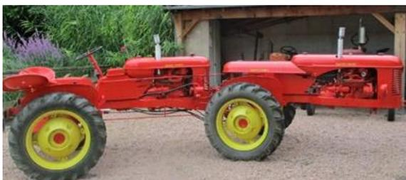
Aussi, chacun pouvait admirer le prototype de deux tracteurs Massey-Harris type « **Pony** », assemblés, à quatre roues motrices, pivotant en son milieu par un système hydraulique.
